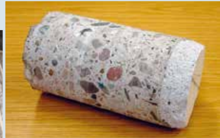
→ Beton-Bohrkern aus einer Gebäudewand
