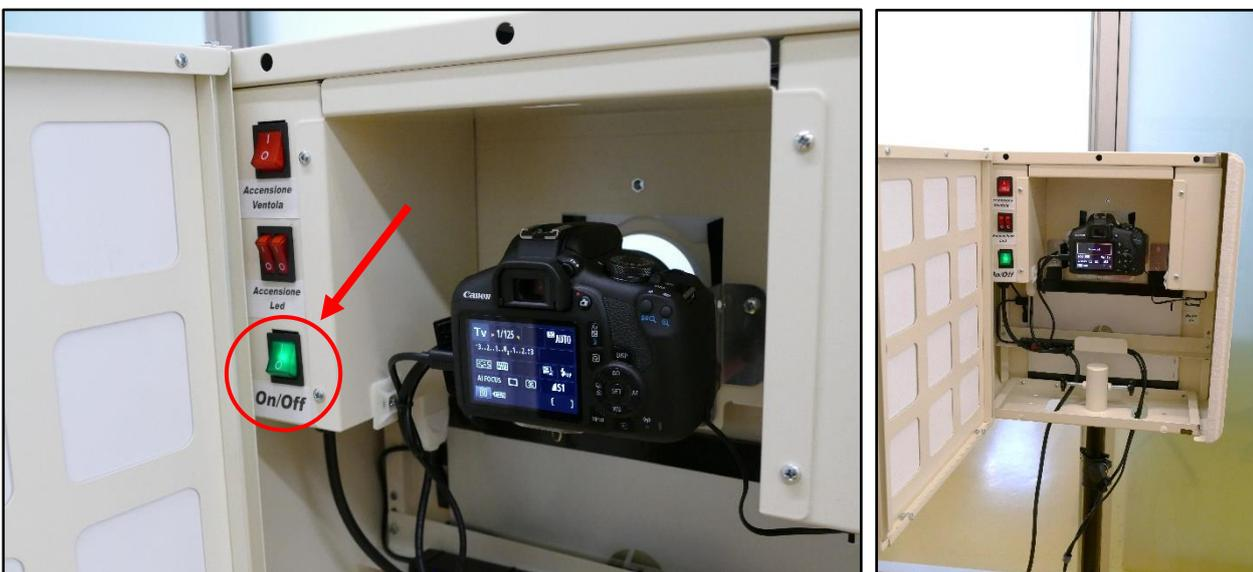
Nun kann man den Verbandskasten hinten mit der grünen Power-Taste (On/Off) einschalten. Die grüne Power-Taste sollte aufleuchten und die Kamera sollte sich eingeschaltet haben. Die oberste rote Taste „Accensione Ventola“ bleibt immer eingeschalten und die zwei roten Tasten „Accensione Led“ können eventuell für zusätzliche Belichtung verwendet werden.
